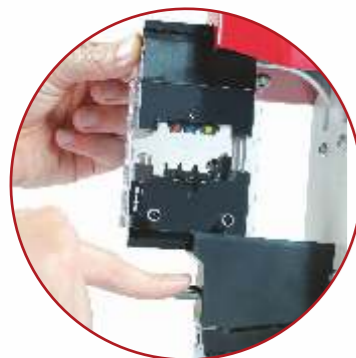
Einfaches Austauschen der Adapter Easy exchange of the adapters Echange facile des adaptateurs
